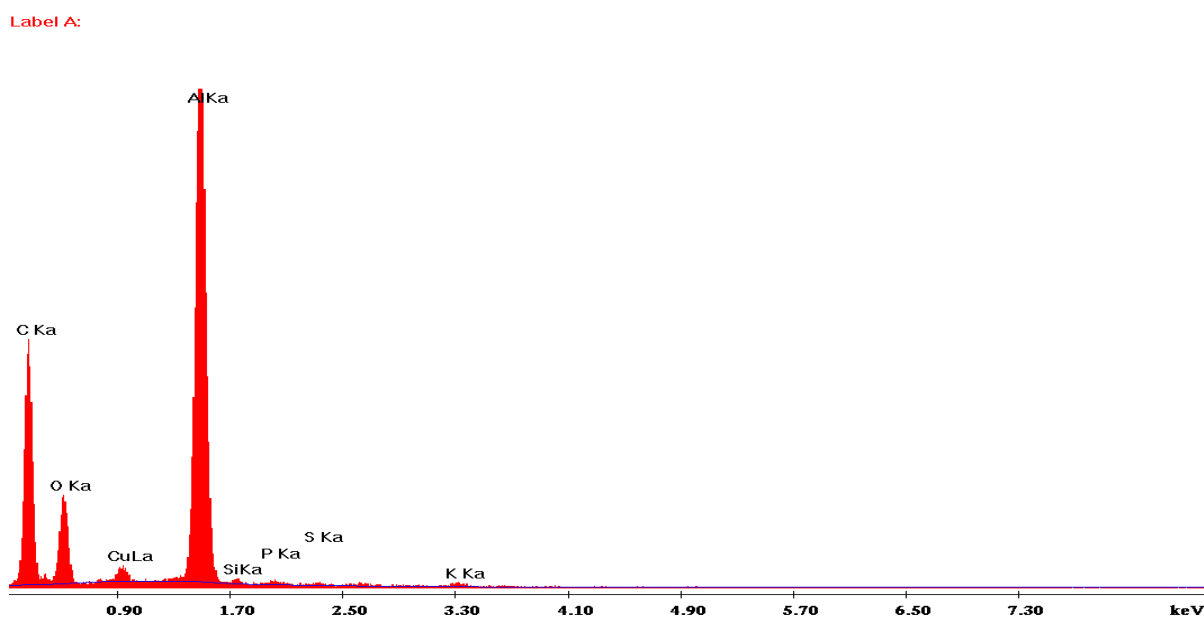
Figura 13: Espectro atómico característico de una partícula de aluminio (Al), (Foto 9: Demostración de partículas abundantes y raras en el cuerpo de una abeja recogida en el apiario número 3T.Figura 9)
